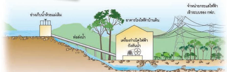
ภาพจำลองการผลิตกระแสไฟฟ้า ของโรงไฟฟ้าพลังน้ำบ้านแม่ใจ อ.แม่แตง จ.เชียงใหม่
